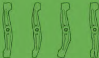
НОРМАЛЬНЫЙ ИЗНОС ЧРЕЗМЕРНЫЙ ИЗНОС ИЗОГНУТЫЙ ТРЕЩИНЫ
